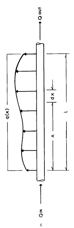
FIGURE 1. PARAMETERS FOR DISTRIBUTED TAKE-OFF.
