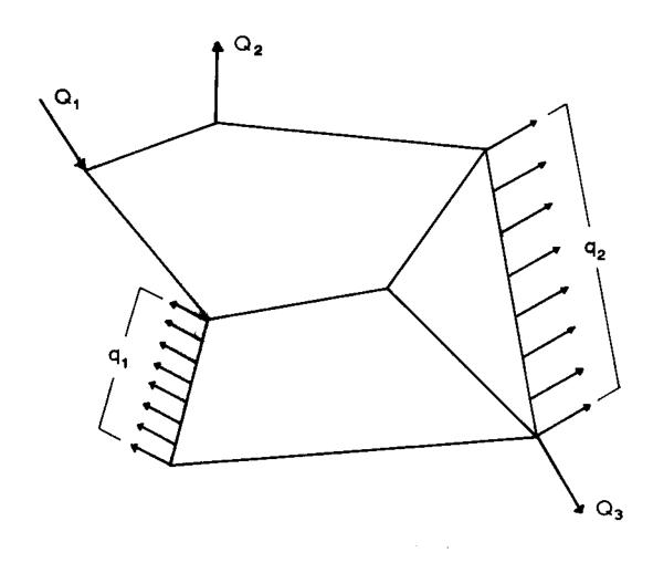
FIGURE 2. DISTRIBUTION SYSTEM INCLUDING LINES WITH DISTRIBUTED TAKE-OFF.
